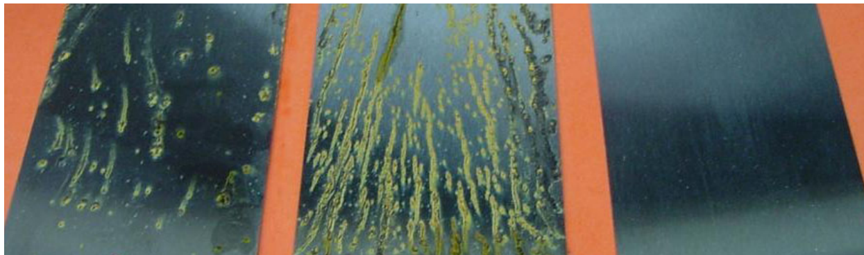
DI Water Control No Galvanic Contact
